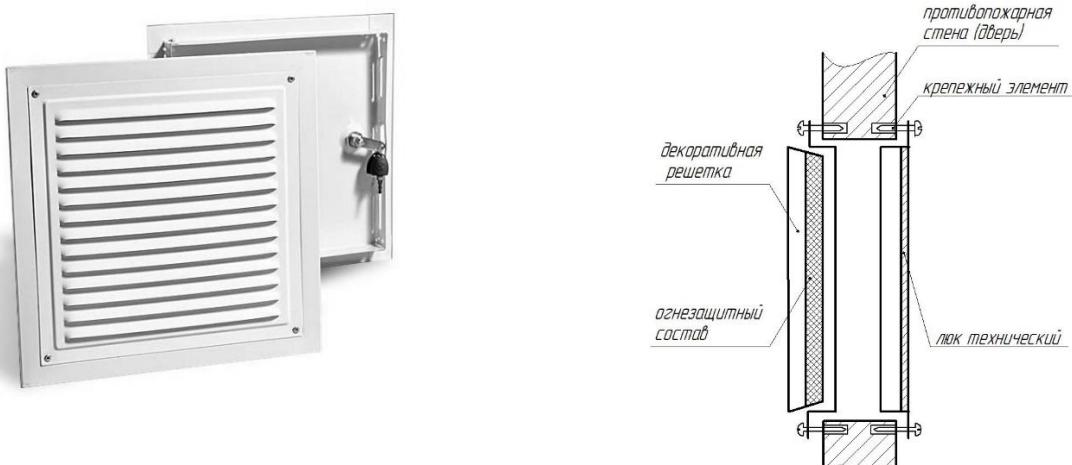
Узел стыковочный состоит из дверцы наружной с замком и панели задней в сборе. Дверца наружная закрывает стыковой узел снаружи на замок и опломбирована. Изнутри помещения стыковочный узел закрыт декоративной решеткой. Панель задняя состоит из каркаса и рабочего клапана.
